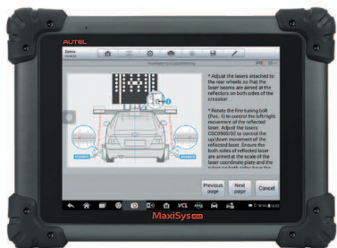
ЛАЗЕРНАЯ НАСТРОЙКА УРОВНЯ СТОЙКИ
